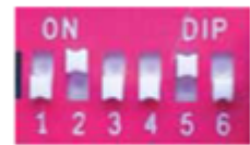
Панель с 6 переключателями
